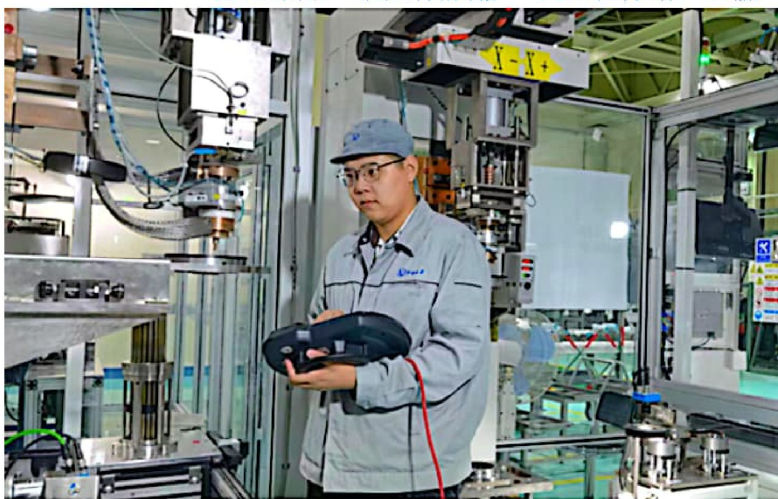
2022年9月，中核北方重水堆核燃料元件厂组件组装车间，中核北方青年职工焦禹凡正在调试全自动端板焊机。受访者供图
